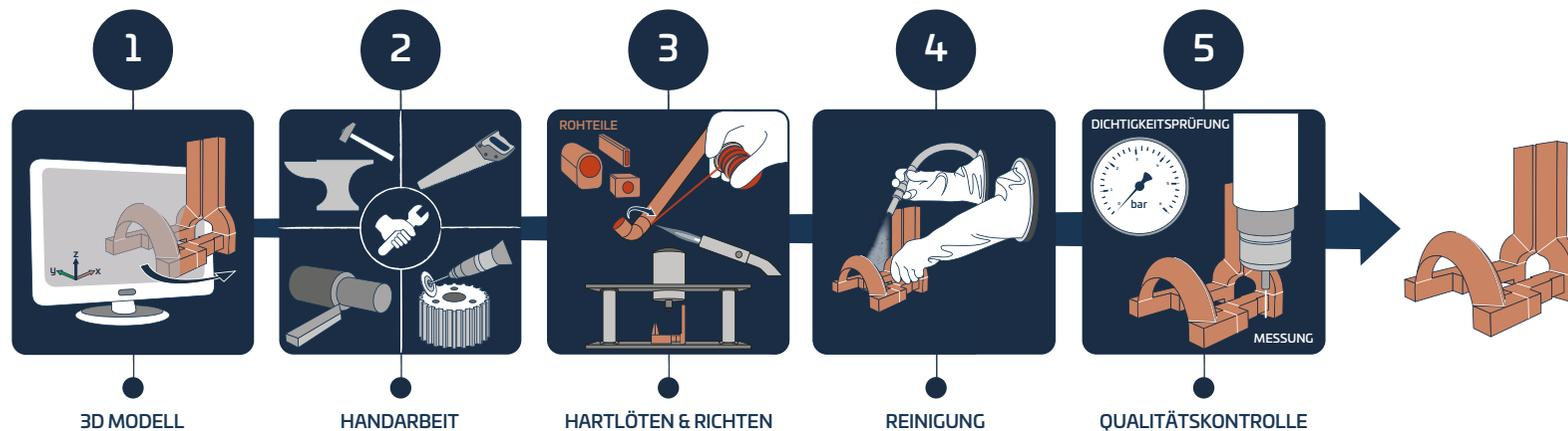
Konventionelle Herstellung von Induktionsspulen
